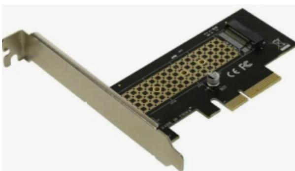
Переходник ORIENT C300E PCI-E 4X-M.2 M-key NVMe SSD, тип 2242/2260/2280, с планками крепления. Адаптер для подключения M.2 NVMe SSD в ПК, комплектуется стандартной и низкопрофильной планкой крепления к корпусу компьютера. Устанавливается в свободный слот PCI Express 3.0 4x. Обеспечивает скорость передачи до 32 Гбит/с (на PCI-E 3.0), до 16 Гбит/с (на PCI-E 2.0). Поддержка NGFF (M.2) M key NVMe SSD, тип 2230/2242/2260/2280.
