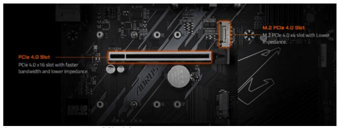
Аппаратная конструкция PCIe 4.0
