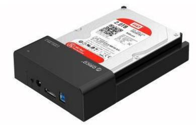
В DS720+ данное устройство распознается как внешний диск eSATA. Очень удобен при необходимости переформатировать диски без вскрытия системного блока.
