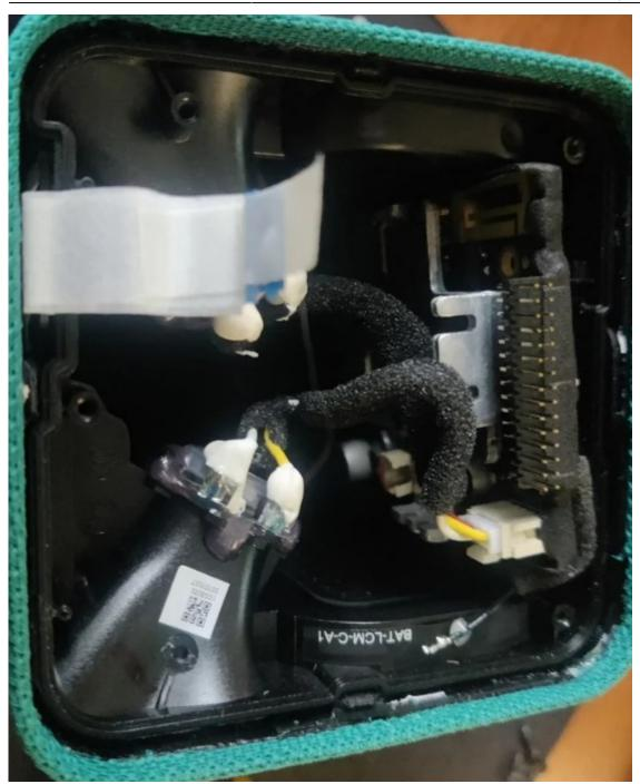
Шаг шестой: откручиваем пять винтов верхней крышки под липкой лентой и с небольшим усилием снимаем, нам будет сопротивляться уплотнитель под крышкой.
