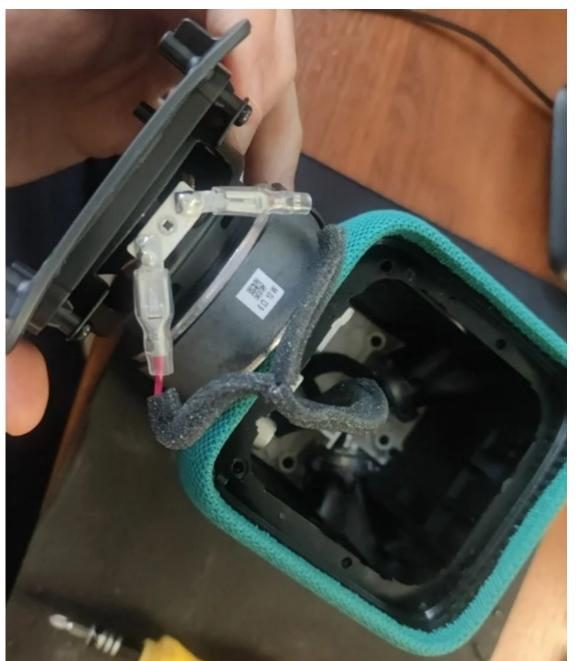
Шаг четвертый: внутри мы видим еще два динамика, поддев язычок отсоединяем разъемы всех трех динамиков от основной платы, всего разъемов два
