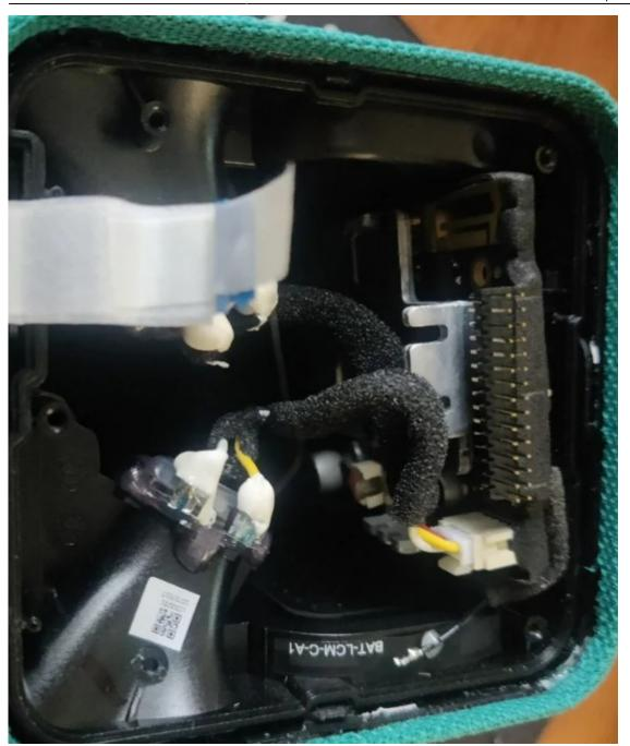
Шаг пятый: внутри колонки откручиваем пять винтов держащих сенсорную панель, открутив снимаем, учитывая, что под ней шлейф, который необходимо отключить. Шлейф закреплен на липкую ленту.
