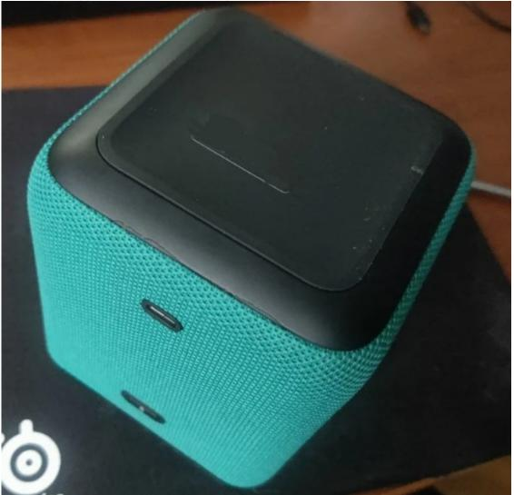
Шаг второй: откручиваем четыре винта в нижней крышке и снимаем, будьте аккуратны под ней находится динамик
