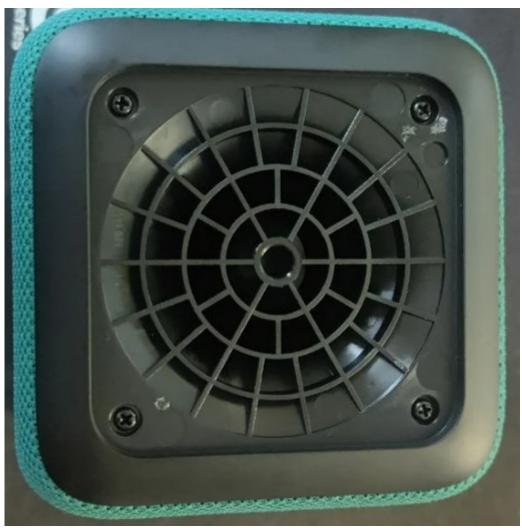
Шаг третий: откручиваем шесть винтов крепления динамика и снимаем, он будет на проводе, достаточной длинны для удобной разборки.
