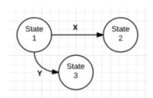
Машина переходит из состояния 1 в состояние 2 для входа X и из состояния 1 в состояние 3 для входа Y. На рисунке 1 состояние начинается в Состоянии 1; состояние меняется на состояние 2 при вводе «X» или на состояние 3 при вводе «Y».
