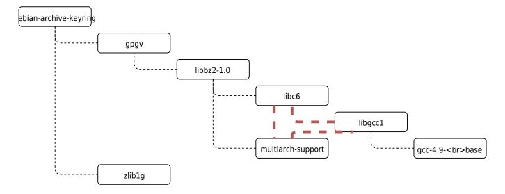
Рисунок 3. Дерево зависимостей Debian-Archive-Keyring, циклическая зависимость выделена красным
