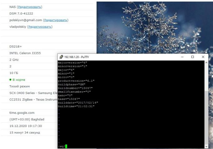
1. Выходим из редактирования нажатием: ESC 2. Последовательно вводим (двоеточие обязательно!): :wq! 3. Подтверждаем нажатием кнопки: ENTER
