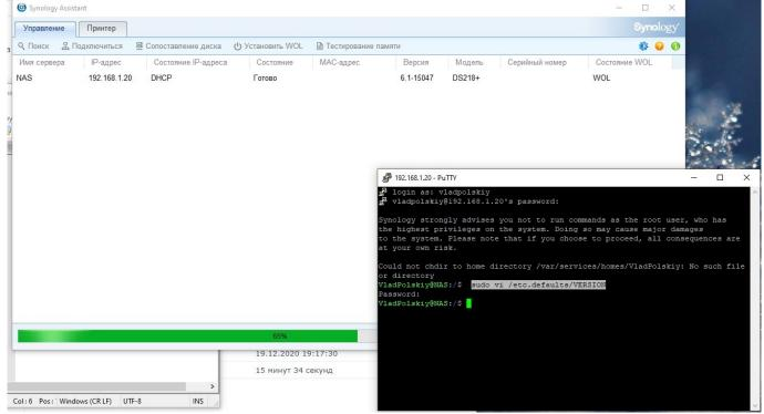
Перегружаем страницу DSM и проверяем версию программы
