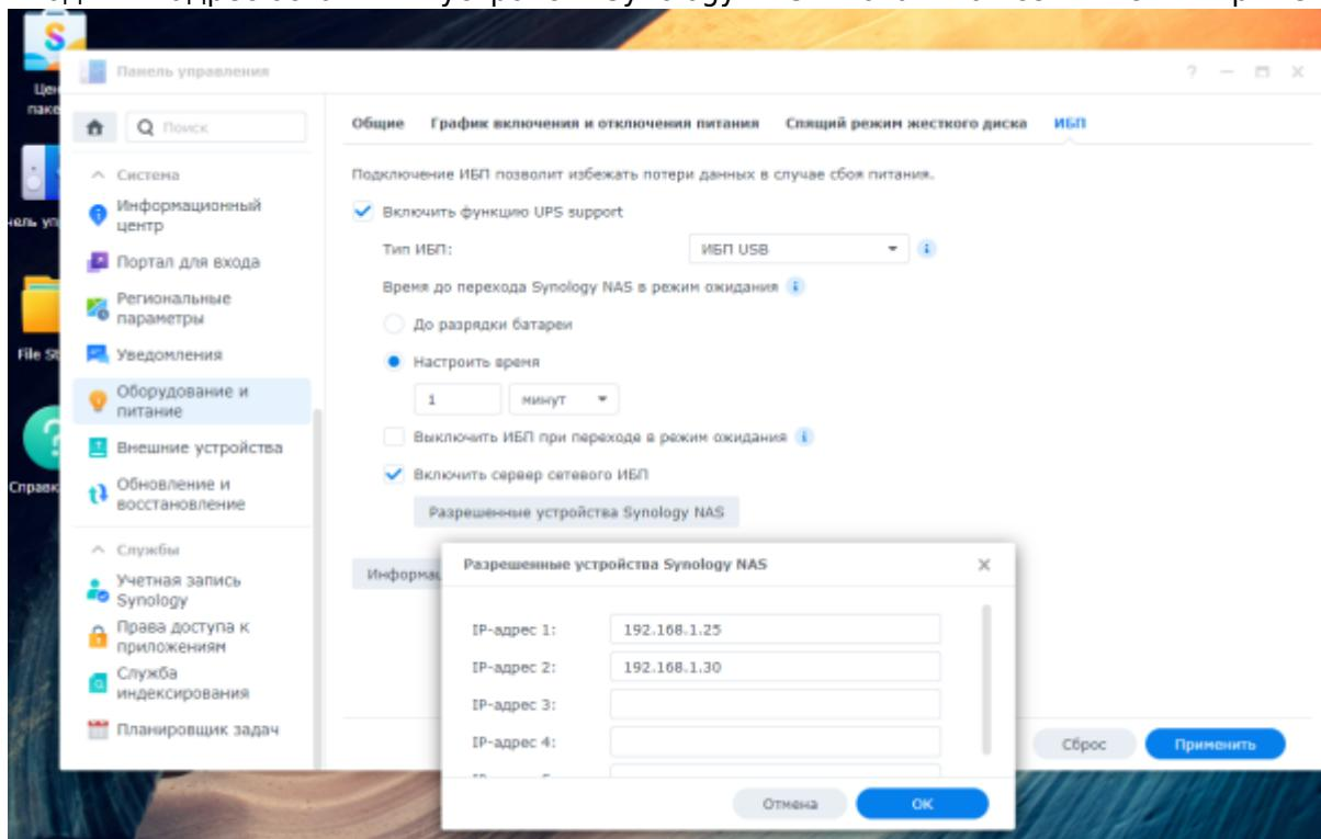
Synology NAS DS720+ → Панель управления → Оборудование и питание → ИБП
