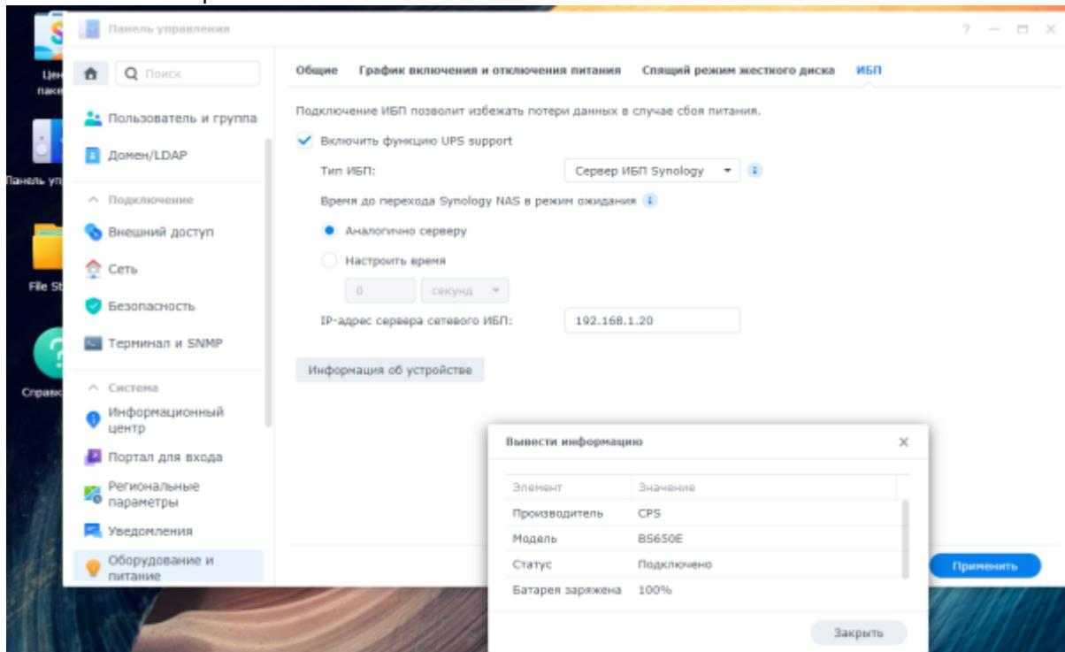
Информация о подключенном ИБП на Synology NAS DS420+, куда ИБП подключен по USB
